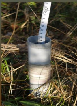
Pomiar głębokości zwierciadła wody za pomocą świstaki z taśmą mierniczą
